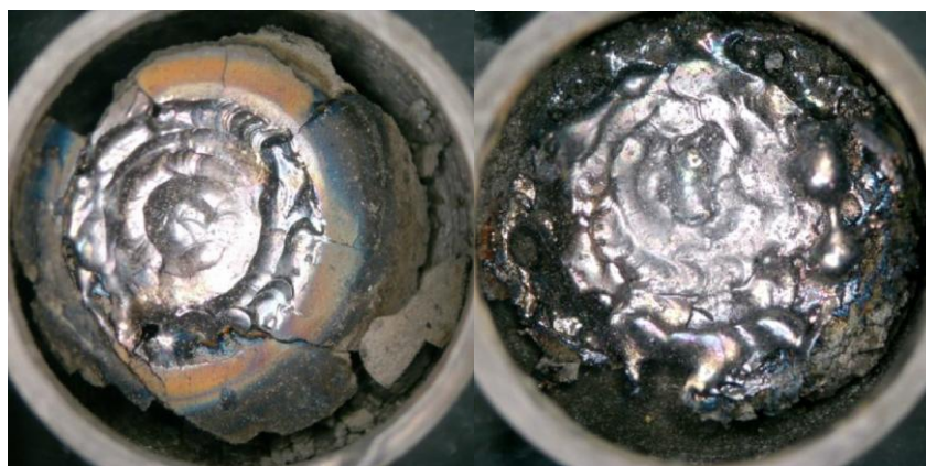
Рис. 1. Образцы плавного карбида гафния, полученные из порошка карбида гафния (слева) и из механокомпозита гафния и углерода (справа) в одинаковых условиях.
